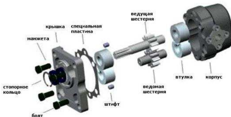
Рис. 4 Насос для подачи компонента «А»
