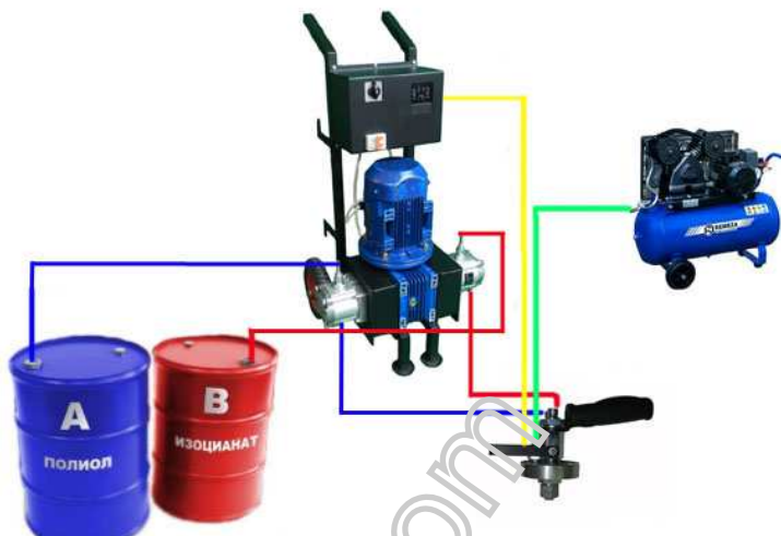
Рис.8 Схема подключения установки для напыления ППУ
