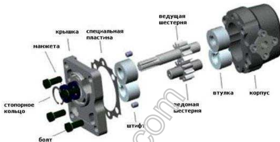
Рис. 5 Детали шестеренного насоса
