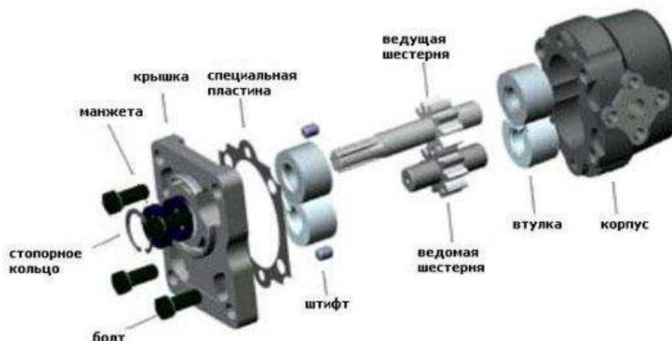
Рис. Детали шестеренного насоса
