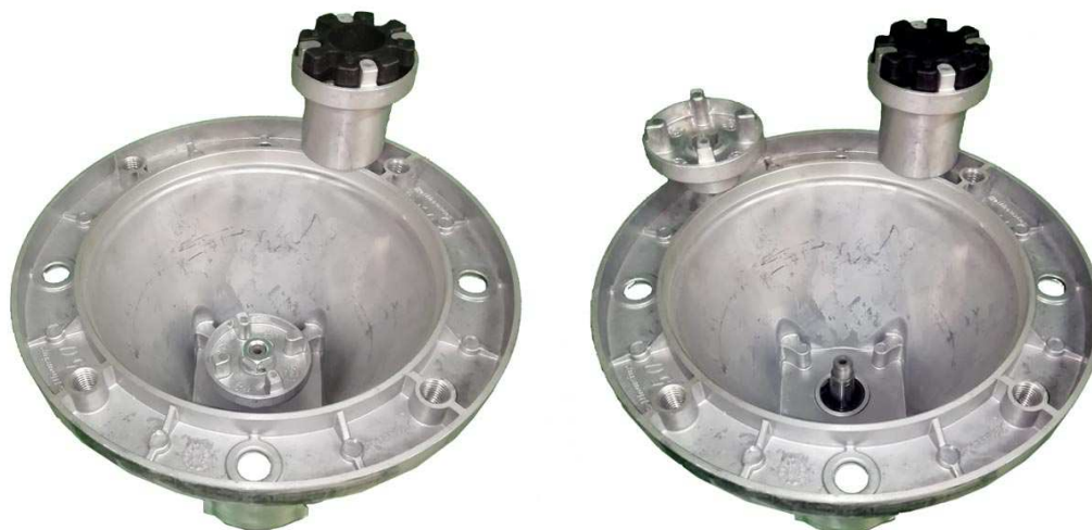
Рис.14 Снятие шестеренного насоса с установки
